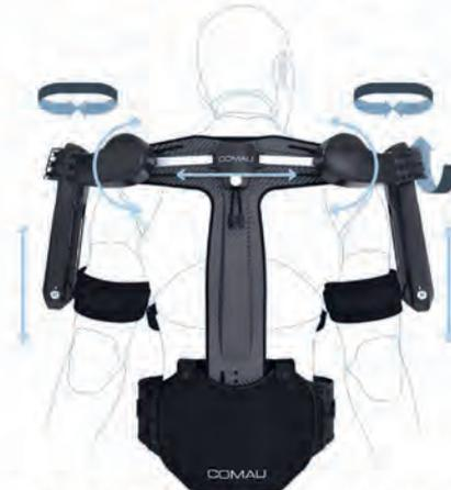
Grâce à une chaîne de degrés de liberté passifs, l'axe de rotation flexion-extension de l'épaule humaine est aligné sur celui de MATE-XT.
